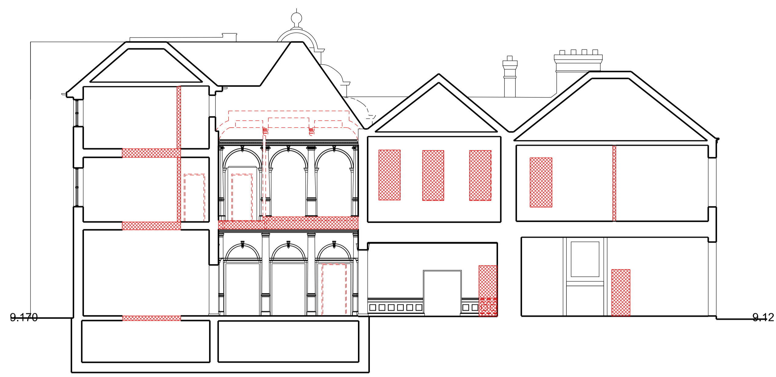
01 Demolition Section A - A SCALE: 1:100
