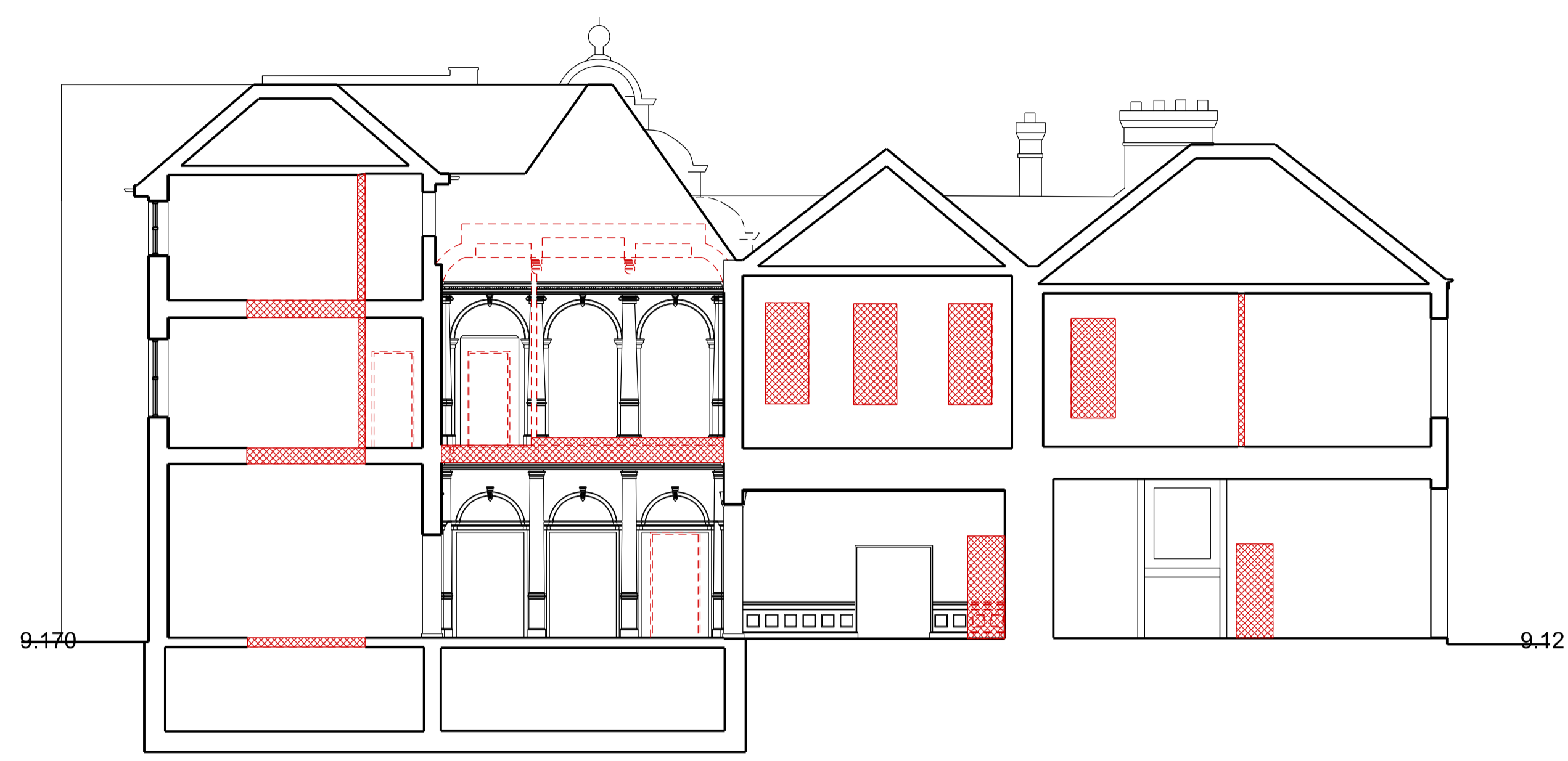
01 Demolition Section A - A SCALE: 1:100
