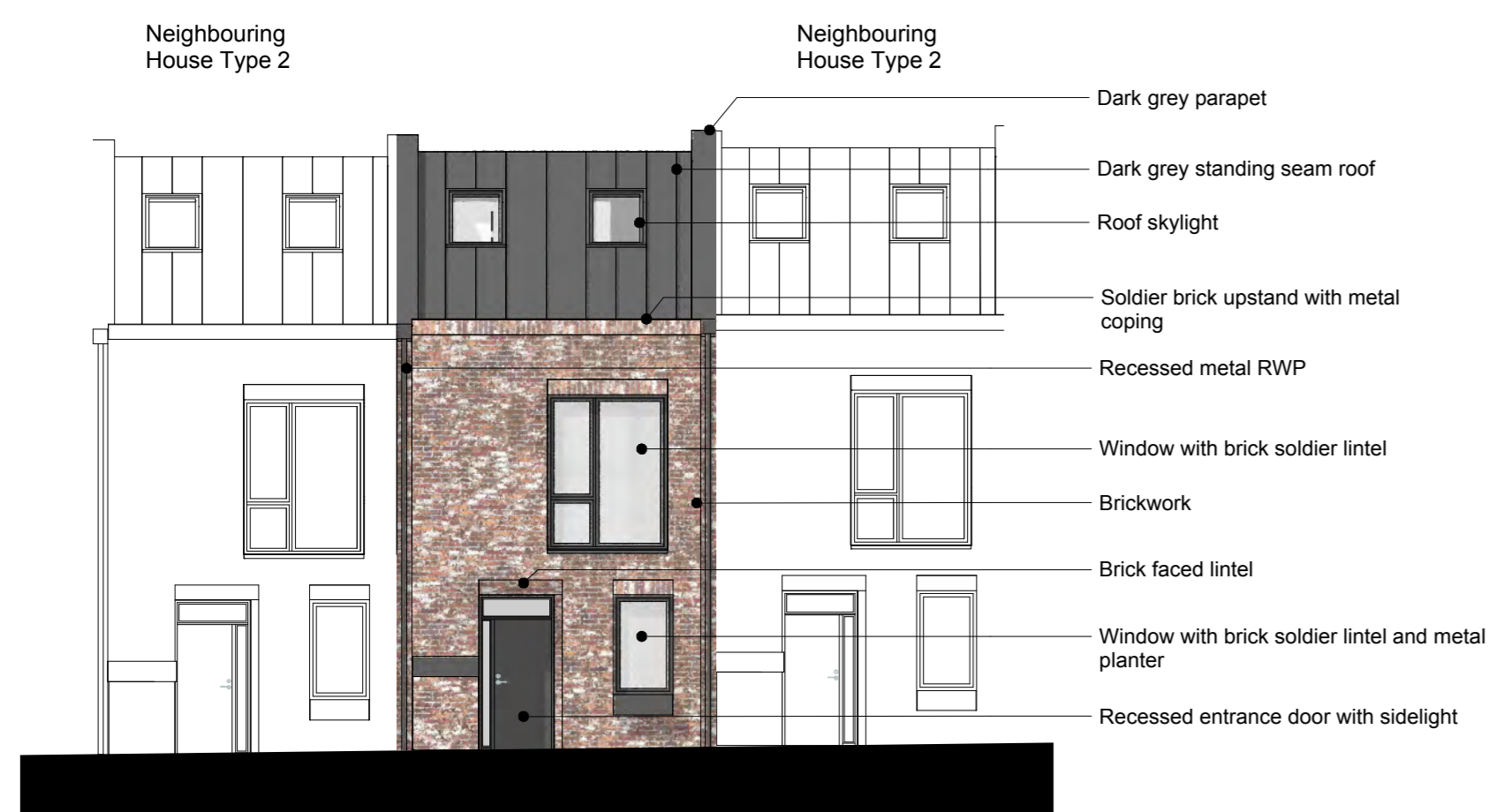
A Front Elevation A Scale: 1:100
