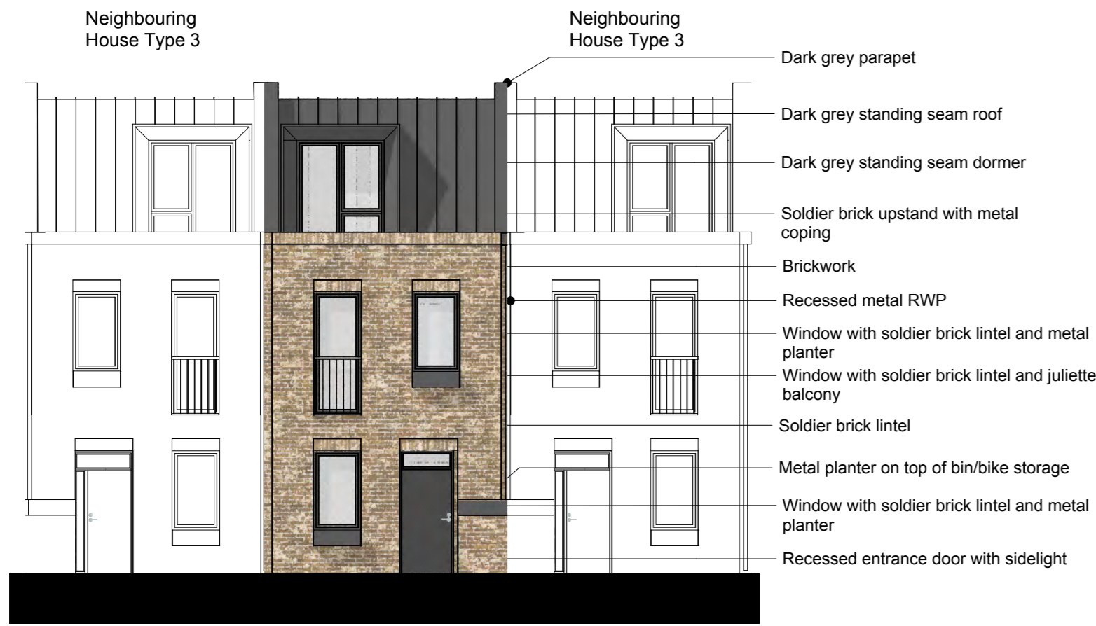
A Front Elevation A Scale: 1:100
