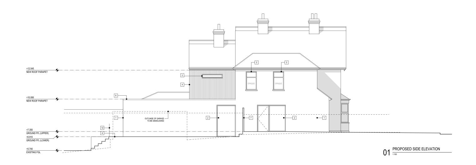
2 GLAZING 8 STONE PAVING 4 VERTICAL TIMBER BATTENS 10 LOG BURNING STOVE/FLUE 5 GLAZED ROOFLIGHT 12 GLASS BALUSTRADE 6 STONE COPING
