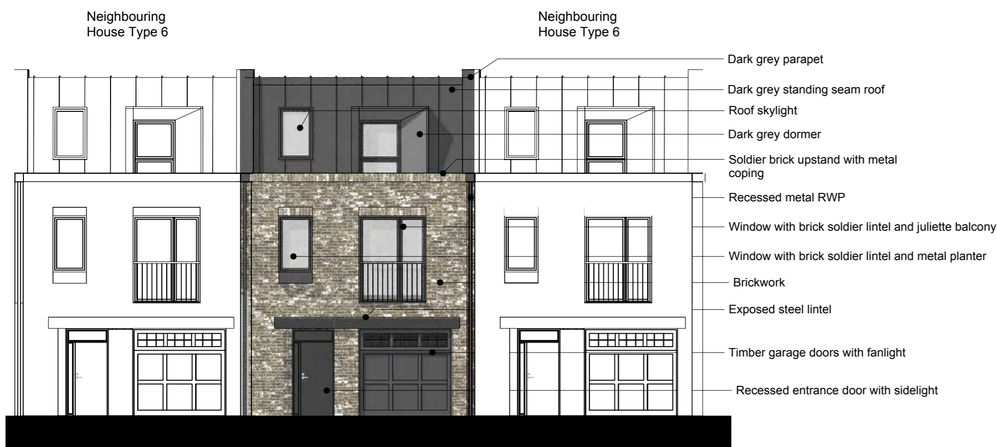
A Front Elevation A Scale: 1:100
